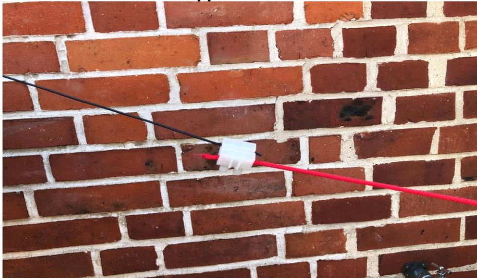
Durch vorsichtiges Kürzen wird nun im 30 m-Band auf bestes SWR angestimmt. Ein SWR von 1 ist möglich. Dann wird die Spule angeschlossen und das SWR erneut gemessen. Es kann sein, dass etwas nachgestimmt werden muss.
